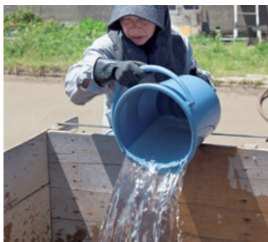
5 4の上から海水をかけ、塩分濃度の高い海水を得る（通常の海水濃度は3%程度。この工程により15%ほどになる）
